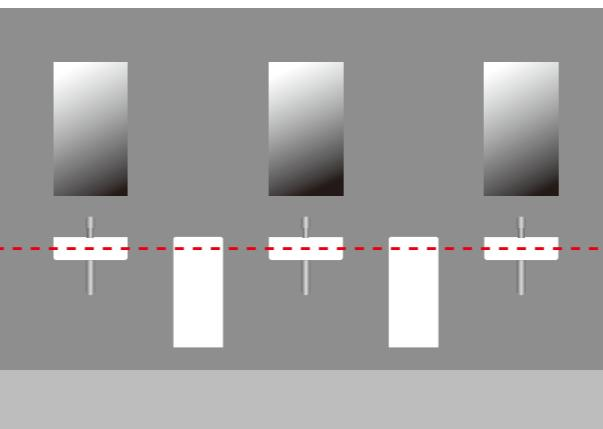
您可以整齊地安裝多部與洗手台齊平的乾手機。
