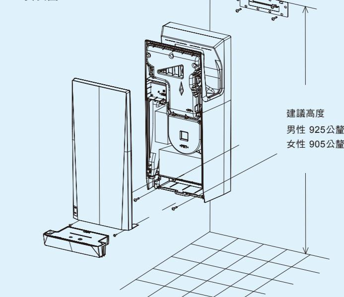
\*要鎖緊主裝置的安裝螺絲時，請使用長度至少150公釐的十字 (+) 螺絲起子。
