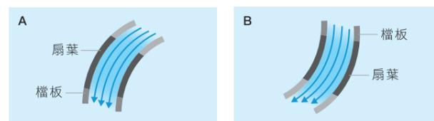
三菱電機獨特的橫流風扇結構引導空氣順利通過每片旋轉的扇葉，同時進行空氣的吸入與排出。高效提供強力清新氣流。
