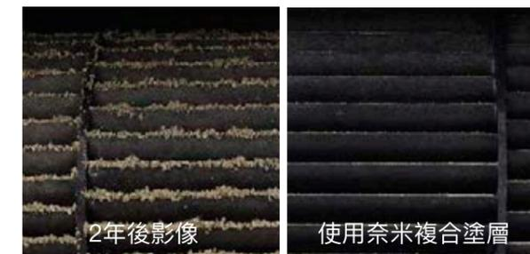
通常灰塵被分為兩類：奈米複合塗層採用「氟微粒」特質以防止親水性灰塵穿透，並結合「親水塗層」避免疏水性髒汙附著。
