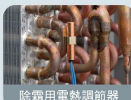
除霜用電熱調節器
