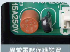
異常電壓保護裝置
