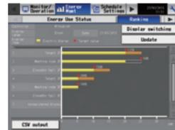
依照空調設備消耗功率排序，並可顯示個別空調裝置和區域，將高負荷區域可視化。此外，也可與目標設定值進行消耗功率比較。
