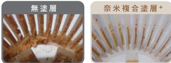
\* 依照本公司實驗標準，使用塑膠試片進行的灰塵吸附實驗結果。
