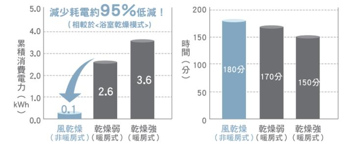
※<測量條件>：在下列條件下使用浴室後，利用結露感應器測量乾燥情況。[1]浴室空間大小：1.6mX2.4mX2.2m [2]外氣溫度20°C，外氣濕度約60%RH [3]浴缸內放水(水溫50°C，流量8公升/每分鐘，20分鐘) [4]使用蓮蓬頭(水溫50°C，8公升/分鐘，20分鐘) [5]蓋上浴缸蓋 [6]啟動浴室乾燥功能 \*耗電量和乾燥時間會因測量條件而有所差異。
