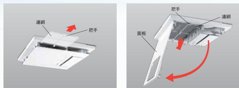
濾網可從面板左、右兩側滑出拆下，或打開面板後取下，清潔輕鬆不費力。
