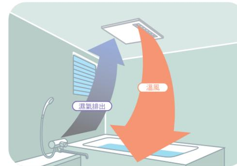
浴室乾燥時的氣流示意圖 (機種：V-141BZ-TWN)
